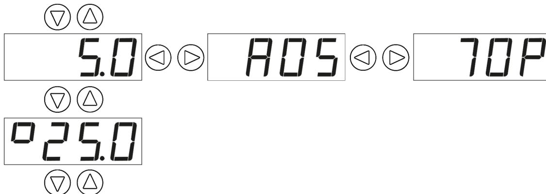
Abbildung 14 Navigieren durch das ECP1000C und ECP3000C Hauptmenü
