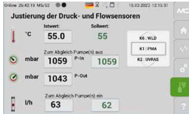
Abb. 71: Justierung der Druck- und Flowsensoren
