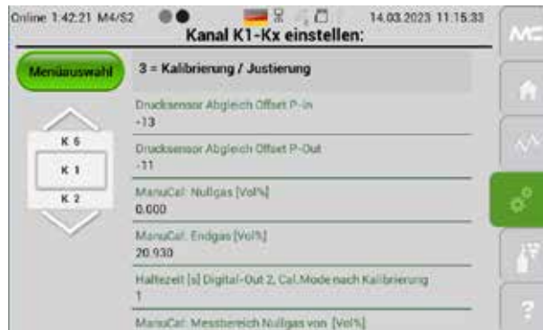
Abb. 76: Einstellungen der kanalspezifischen Kalibrierparameter
