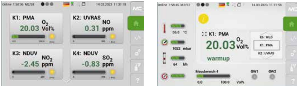
Abb. 73: Bildschirm M2/S1 mit Anzeige (gelbe LED) und M2/S2 in der Aufwärmphase
