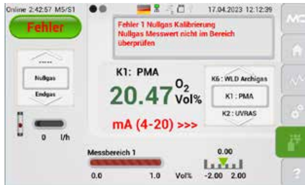
Abb. 84: Fehler bei der manuellen Kalibrierung
