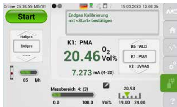
Abb. 77: Manuelle Kalibrierung mit Endgas
