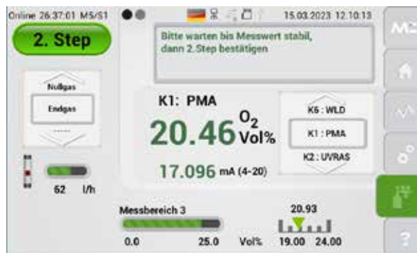
Abb. 79: Zweiter Schritt der manuellen Kalibrierung
