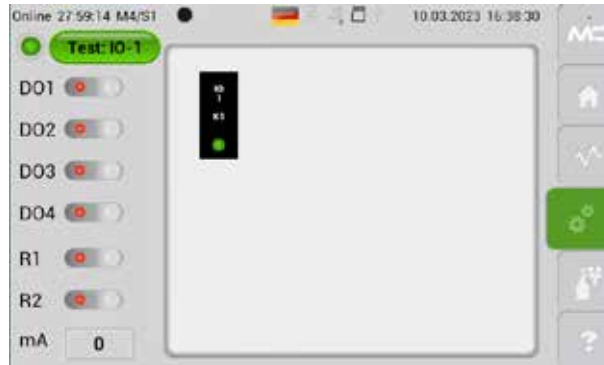
Abb. 67: IO1-Komponenten: DO1 bis 4, Relais-Ausgänge R1, R2 und mA-Ausgang
