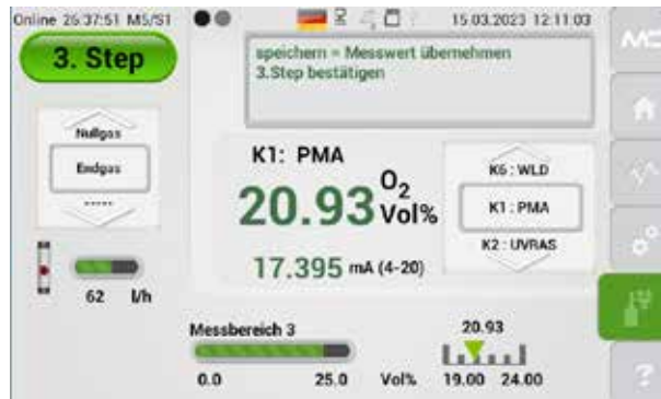
Abb. 80: Dritter Schritt der manuellen Kalibrierung
