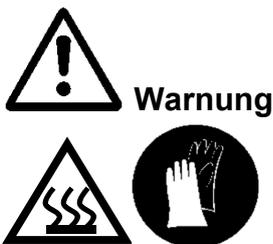
Achtung, bei Umgebungstemperaturen größer 40 °C ist die Temperatur an der Schutz- oder Isolierhaube größer 60 °C!
