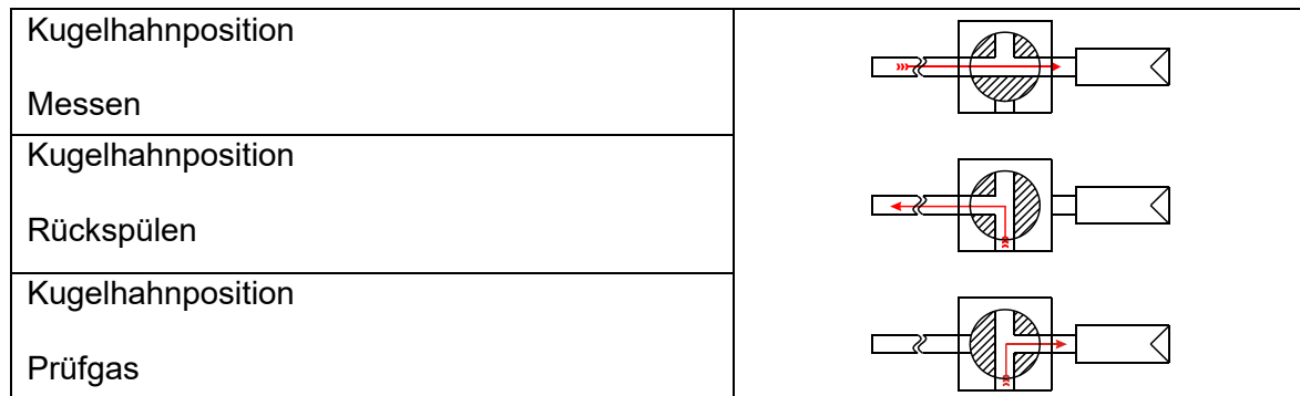
Abbildung 3 Funktionsschema der Option 3/2-Wege-Kugelhahn /3VA
